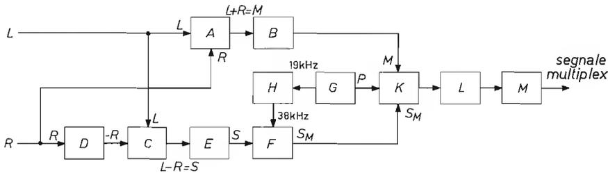
Figura 6.1 - Schema a blocchi di un generatore multiplex.
