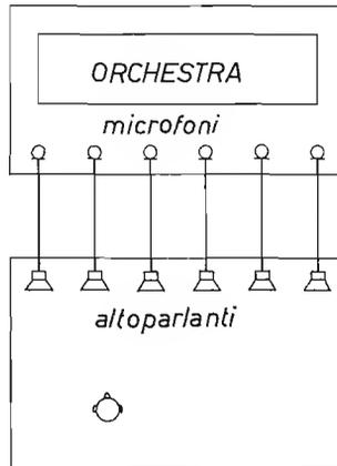
Figura 1-4. - Trasmissione stereofonica mediante vari microfoni e altoparlanti.
