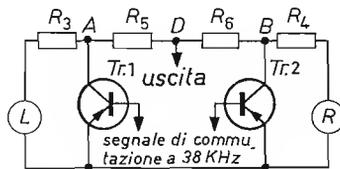
Figura 6.5. - Commutatore elettronico
