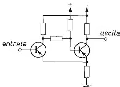
Figura 6-6. - Schema del trigger di Schmitt.
