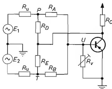
Figura 8.13 - Schema di principio del circuito di compensazione della diafonia con un transistor.
