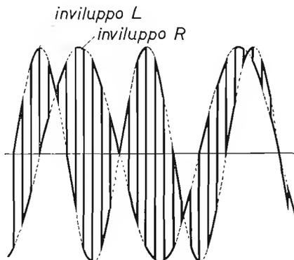
Figura 6.2. - Forma d'onda dei segnali  $L$  e  $R$  commutati.
