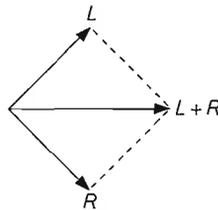
Figura 2.1 - Movimento della puntina in un fonorivelatore stereofonico.
