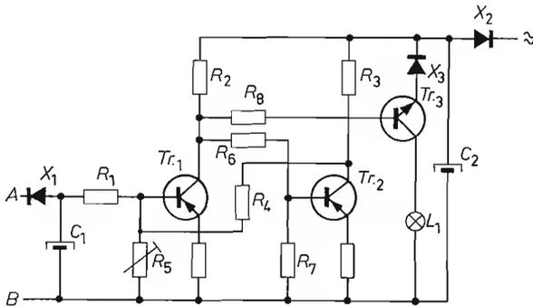
Figura 8.19 - Schema di principio dell'indicatore Philips.
