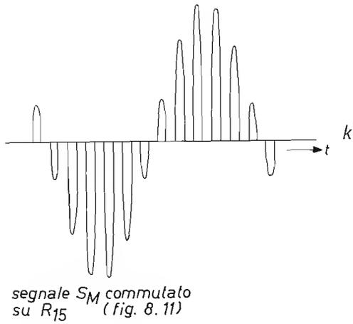
L'analisi delle figure mostra che  $f$  e  $h$  contengono il segnale  $M$ ,  $g$  il segnale  $S$  e  $k$  il segnale  $S$  sfasato di  $180^\circ$ . Inoltre in ciascuno dei segnali sono anche presenti armoniche di  $S_M$ , le quali successivamente vengono filtrate.
