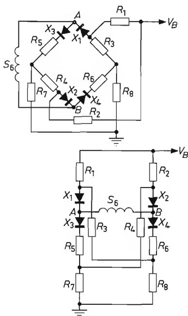
Figura 8.16 - Preregolazione dei diodi del rivelatore a commutazione.
