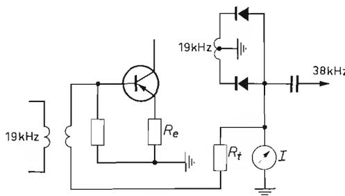
Figura 8.22 - Particolare di un decodificatore con commutatore automatico mono-stereo.
