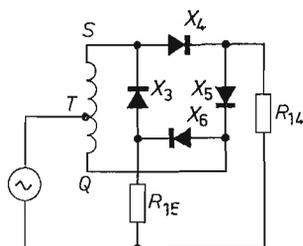
Figura 8.11 - Principio del rivelatore a commutazione.
