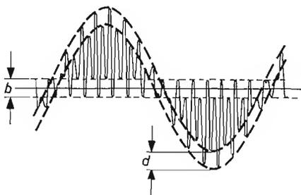
Figura 9.3 - Prova di fase del segnale pilota.
