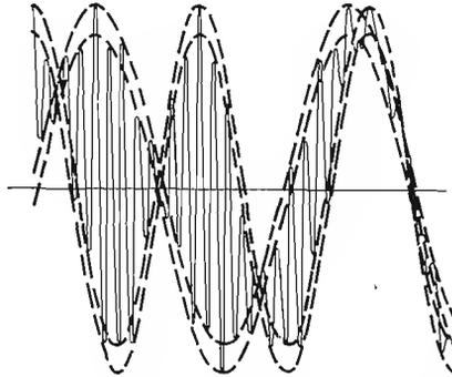
Figura 5.7 - Forma d'onda del segnale multiplex.
