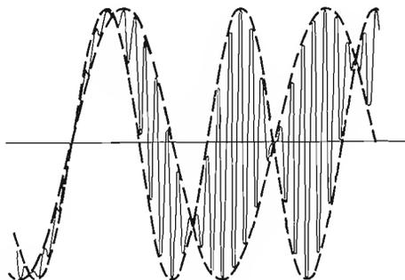
Figura 5.4 - Forma d'onda del segnale composto  $M + S_M$ .
