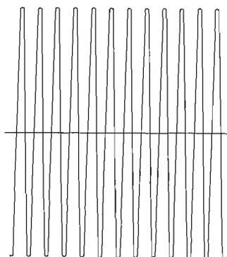
Figura 8.2 - Sottoportante per il segnale multiplex di fig. 8.1.
